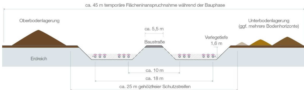
Abbildung 3: Regelgrabenprofil 380-kV-Leitung mit beispielhafter Bodenlagerung
