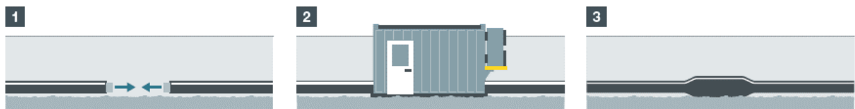
Abb. 7: Schematische Darstellung der Kabelverbindungen (Muffen)
