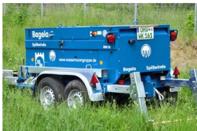
Abb. 29: Kabelziehwinde (beispielhaft Fa. Bagela)
