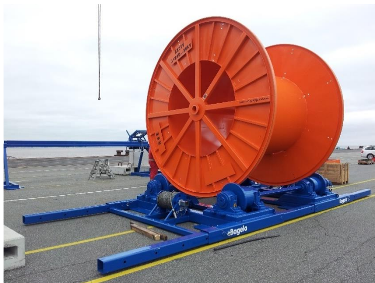
Abb. 28: Trommelbock (beispielhaft Fa. Bagela)
