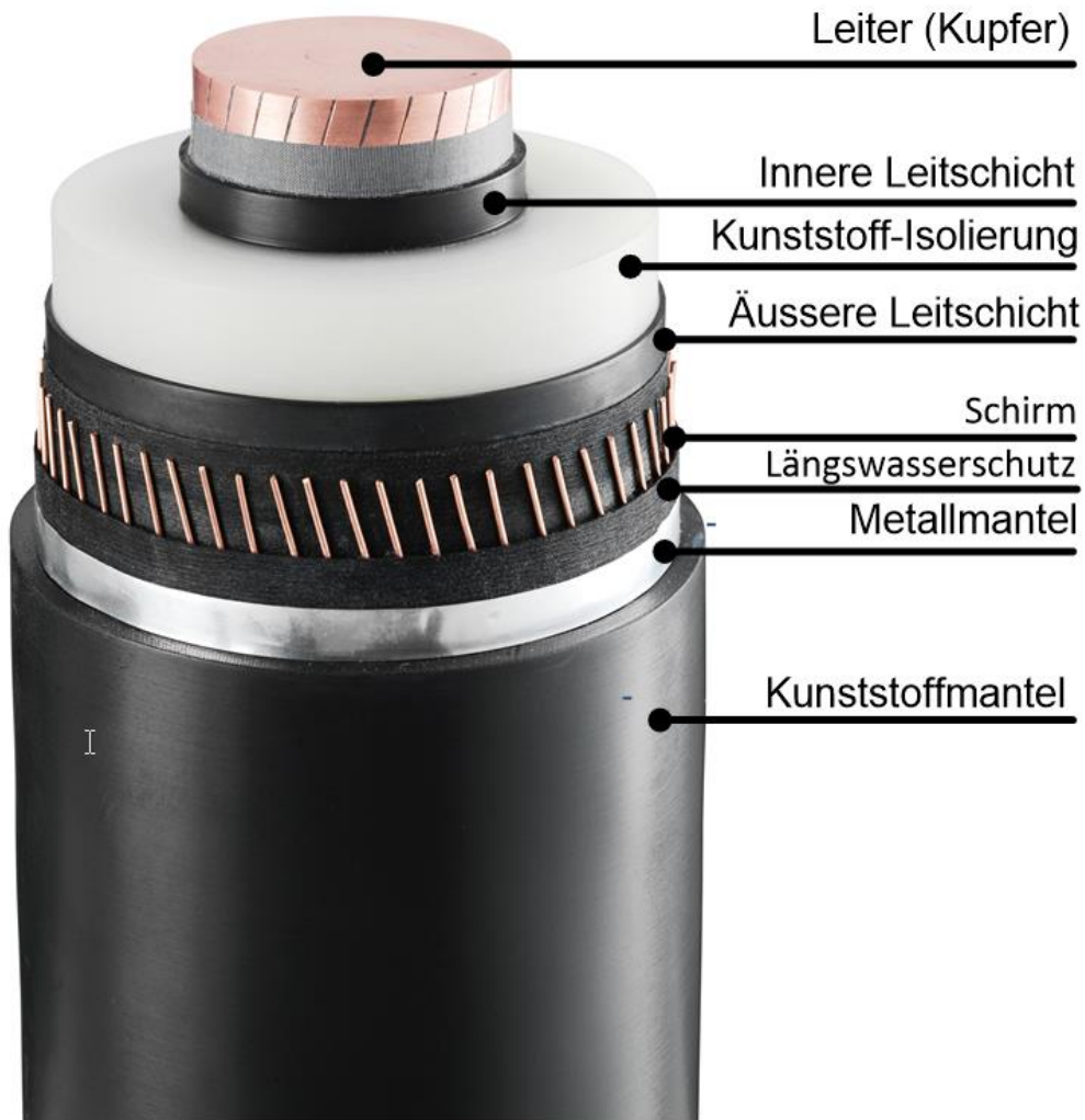
Abbildung 5: Kabelaufbau DC kunststoffisoliertes Erdkabel, beispielhaft mit Kupfer-Leiter
