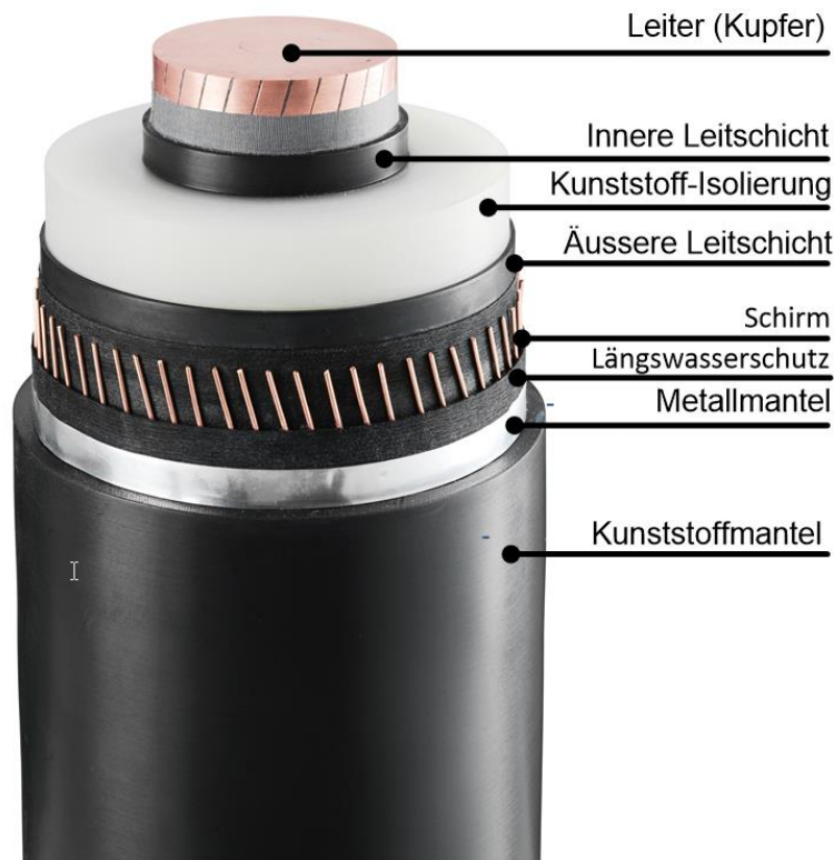
Abbildung 8: Kabelaufbau DC kunststoffisoliertes Erdkabel, beispielhaft mit Kupfer-Leiter
