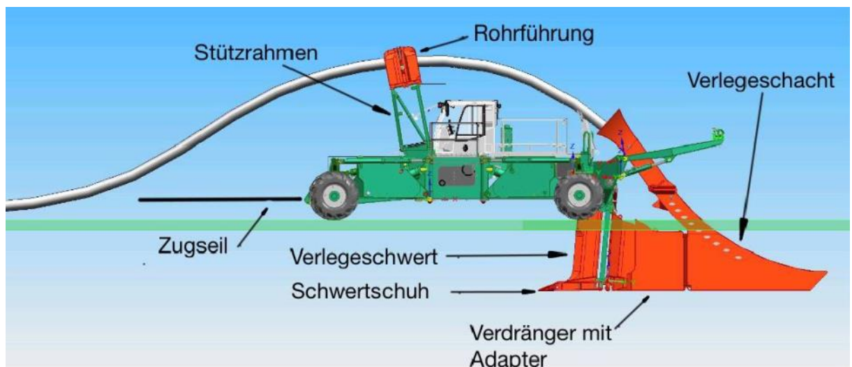
Abbildung 17: Beispielhafte Darstellung des Verlegepfluges (Rohrstrang S-Form)
