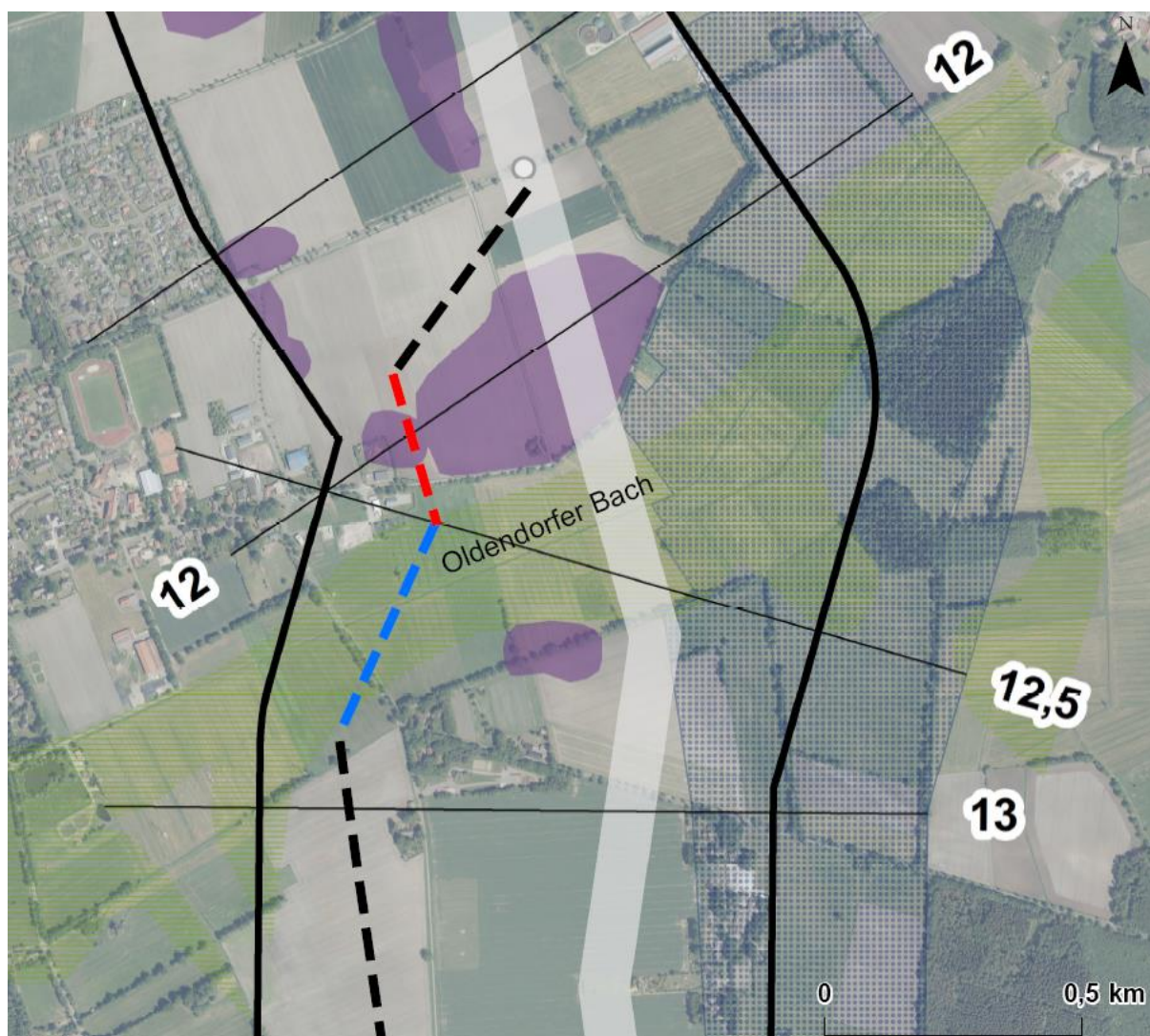
Abbildung 6: Trassenvorschlag (hellgrauer Streifen) und geprüfte nicht in Frage kommende Alternative (gestrichelte Linie) in Segment 006, km 11,7 – km 13,4
