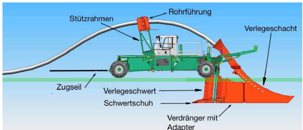
Abbildung 16: Beispielhafte Darstellung des Verlegepfluges (Rohrstrang S-Form)
