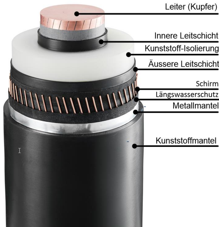
Abbildung 7: Kabelaufbau DC kunststoffisoliertes Erdkabel, beispielhaft mit Kupfer-Leiter
