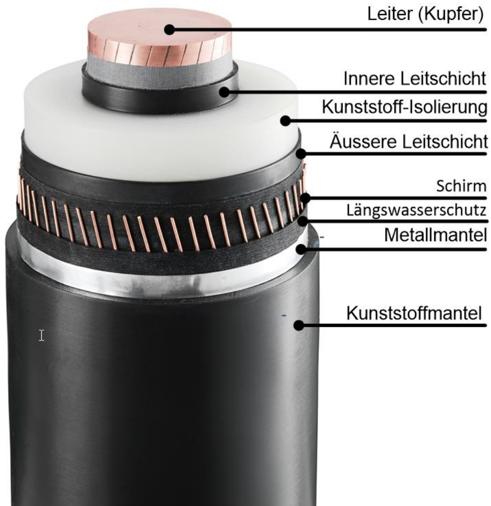
Abbildung 5: Kabelaufbau DC kunststoffisoliertes Erdkabel, beispielhaft mit Kupfer-Leiter
