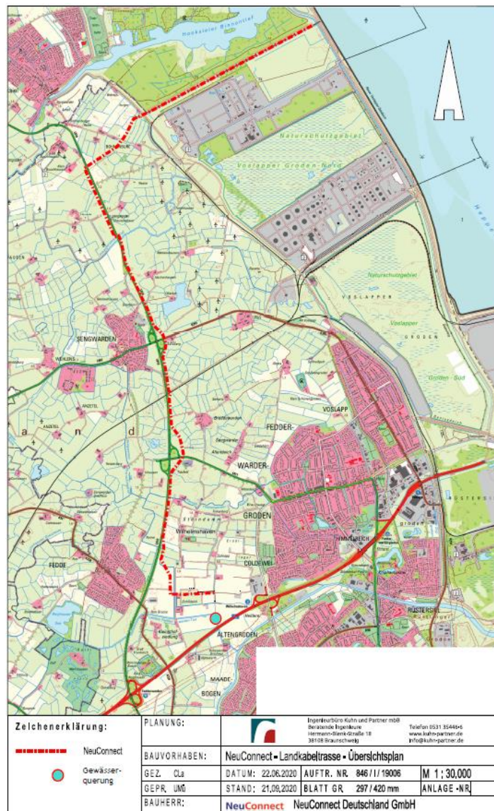
Abbildung 9: Onshore-Trassenverlauf vom Anlandungspunkt zum Konverterstandort.
